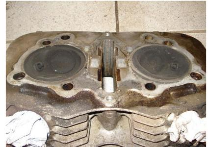
Zylinderkopf Einzyl.-version mit eingefräster Kante linker Brennraum im Bild
