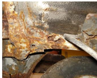
Federaufnahme, Querträger, Längsträger hinten
