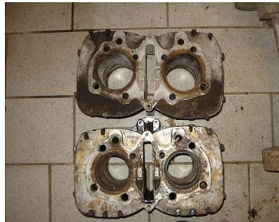
Zylinderblöcke oben 600cc unten gedrosselt kleinere Bohrungen
