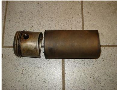
Zylinderbuchse mit Kolben
